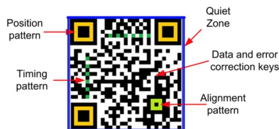
Figuur 2 | Aanduiding van verschillende delen binnen QR-code. De positie van het position pattern, timing pattern, quiet zone, alignment pattern, de data en error correctie worden weergegeven (Vazquez-Brseno, 2012)
